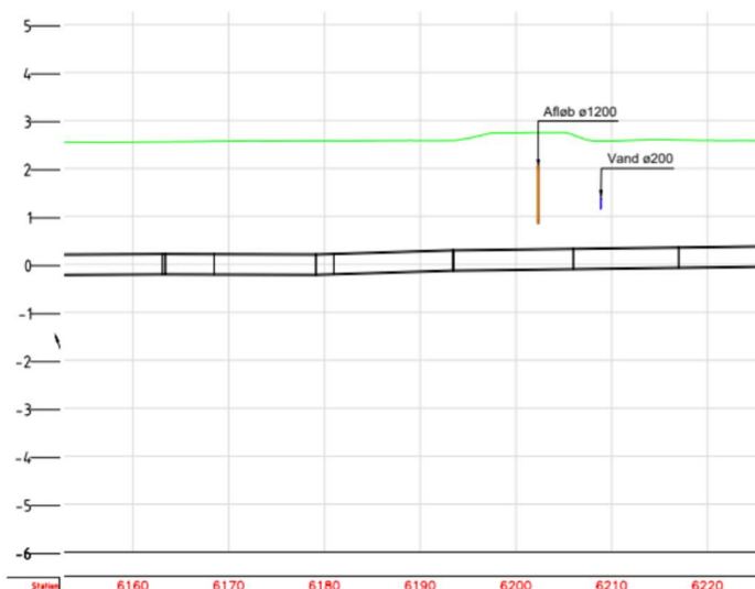
Figur 7: Længdeprofil af linjeføring ved krydsning af Hovedgrøften.
